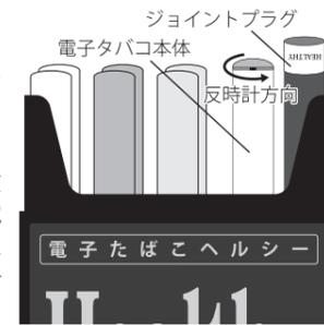
3、付属のカートリッジ (3 種類の中から任意に 1 つ選ぶ) をジョイントプラグの反対側に装着します。挿入がきつい場合は左右に回しながら入れてください。
